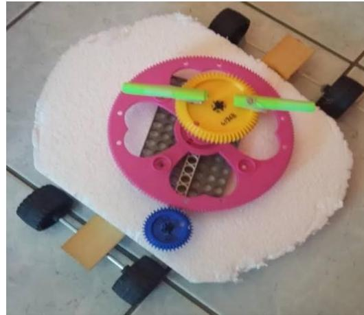
Montage intérieur du char. L'axe de la roue dentée bleue doit transpercer le polystyrène, cet axe sera la manivelle permettant d'actionner le mécanisme.
