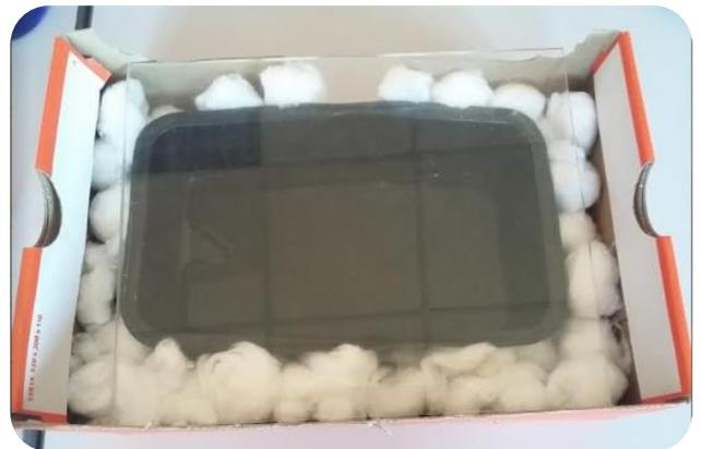
**Autre possibilité:** avec le papier aluminium, isolant et plaque transparente.
