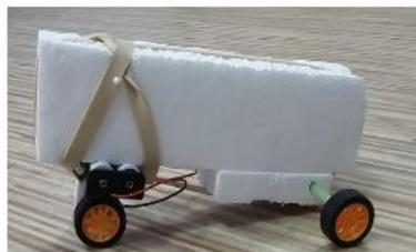
5) Le véhicule est maintenant terminé, nous faisons les branchements entre le moteur et le support des piles.
