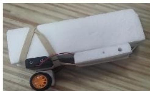
4) Dans le trou réalisé, on place une paille (que l'on pourra retailer à la bonne taille) on place ensuite l'essieu et les roues.
